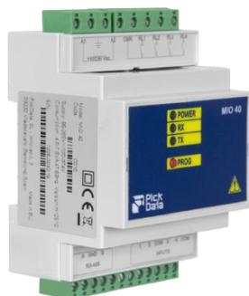
**MIO 40** es un equipo centralizador de contadores de energía con 4 entradas digitales (optoaisladas) para la lectura de impulsos que procedan de los contadores eléctricos, de agua, gas, etc. El valor de los impulsos se guarda en memoria.
